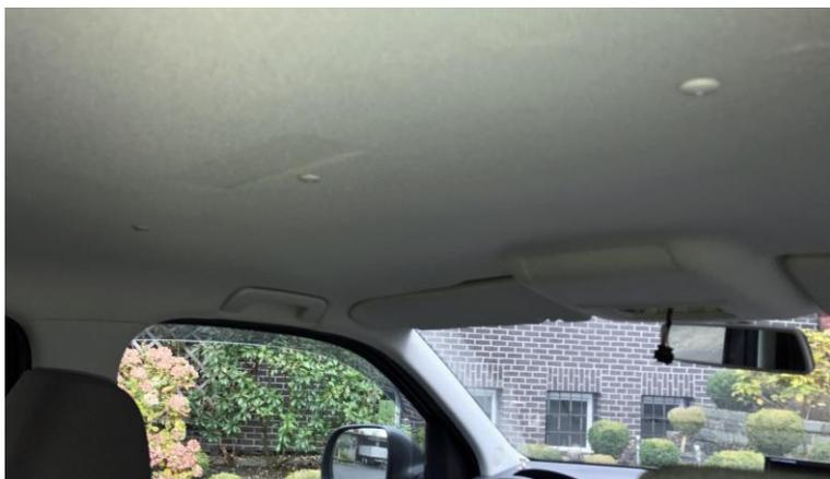
Dachhimmel ohne Möglichkeit zur Montage einer Dachkonsole.
