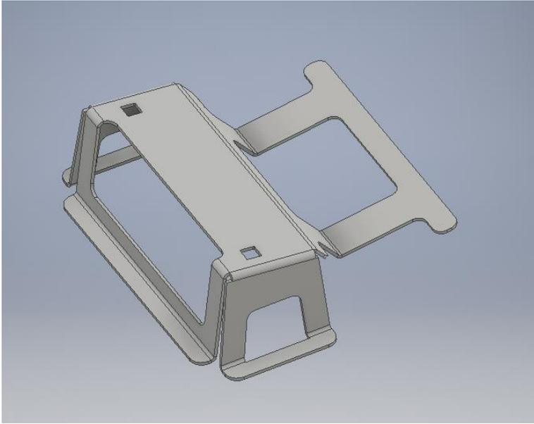
Adapter zur Montage der Dachkonsole.
